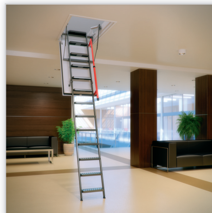
Schody LMF. Wyposażenie: biała klapa ognioodporna, mechanizm odciążający drabinkę w poręczy, wysuwane stopki, stalowa skrzynka, system szybkiego montażu, metalowe listwy wykończeniowe. Cechy szczególne: klasa odporności ogniowej EI 1 =120 min. Maks. wys. pomieszczenia [cm]: 280 i 305. Maks. dop. obciążenie [kg]: 200. Izolacja termiczna [cm]: 8.
