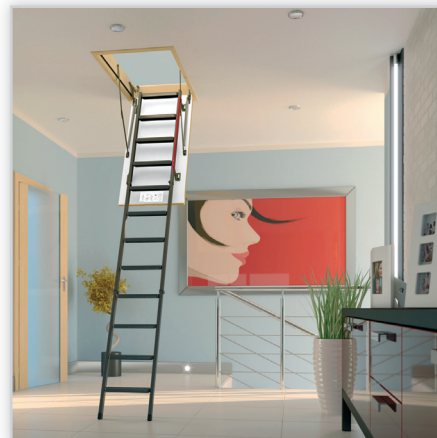
Schody LMS/LMK. Wyposażenie: LMS – beżowa klapa termoizolacyjna, plastikowe stopki, LMK – biała klapa termoizolacyjna, poręcz, plastikowe stopki. Cechy szczególne: wysoki komfort użytkowania. Maks. wys. pomieszczenia [cm]: 280 i 305. Maks. dopuszczalne obciążenie [kg]: 200. Izolacja termiczna [cm]: 3.
